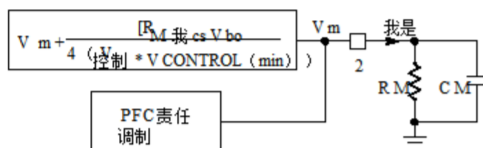
图 35. 乘法器上的外部连接电压引脚
