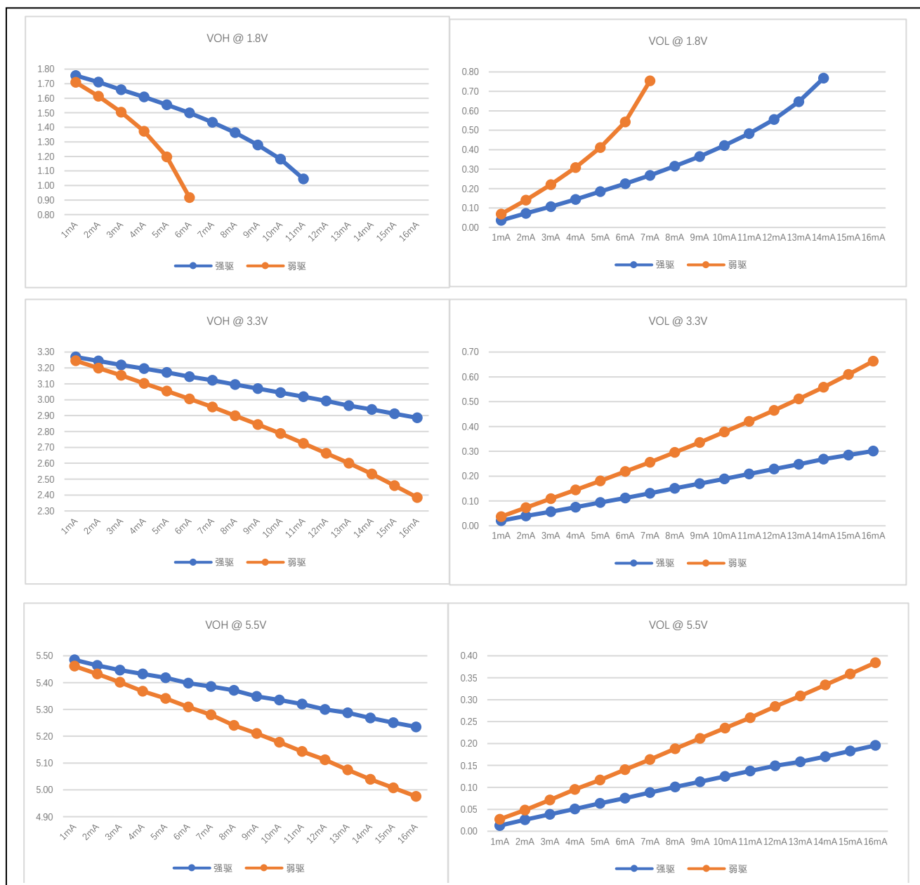
图 7-2 输出端口 VOH/VOL 实测曲线
