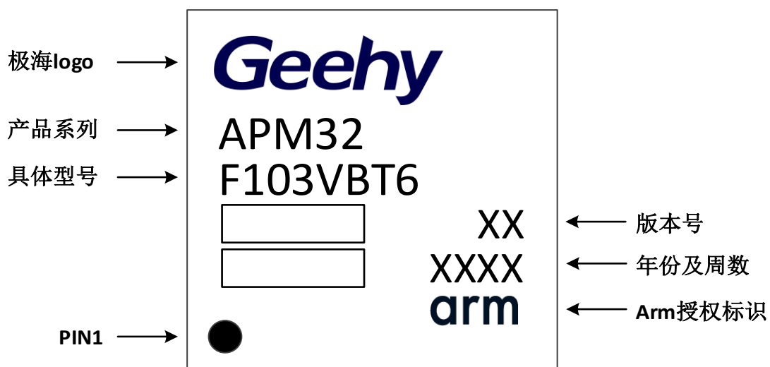
图23 LQFP100 - 100 引脚，14 x 14mm 封装标识
