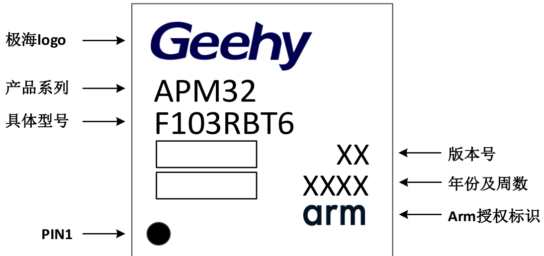
图26 LQFP64 - 64 引脚，10 x 10mm 封装标识
