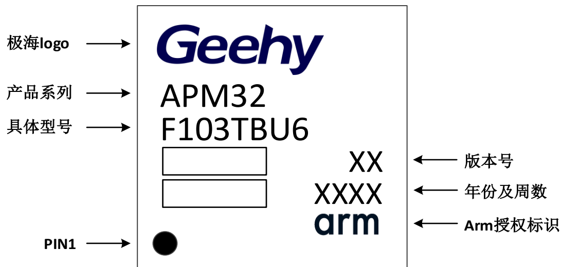
图32 QFN36 - 36 引脚，6 x 6 mm 标识图
