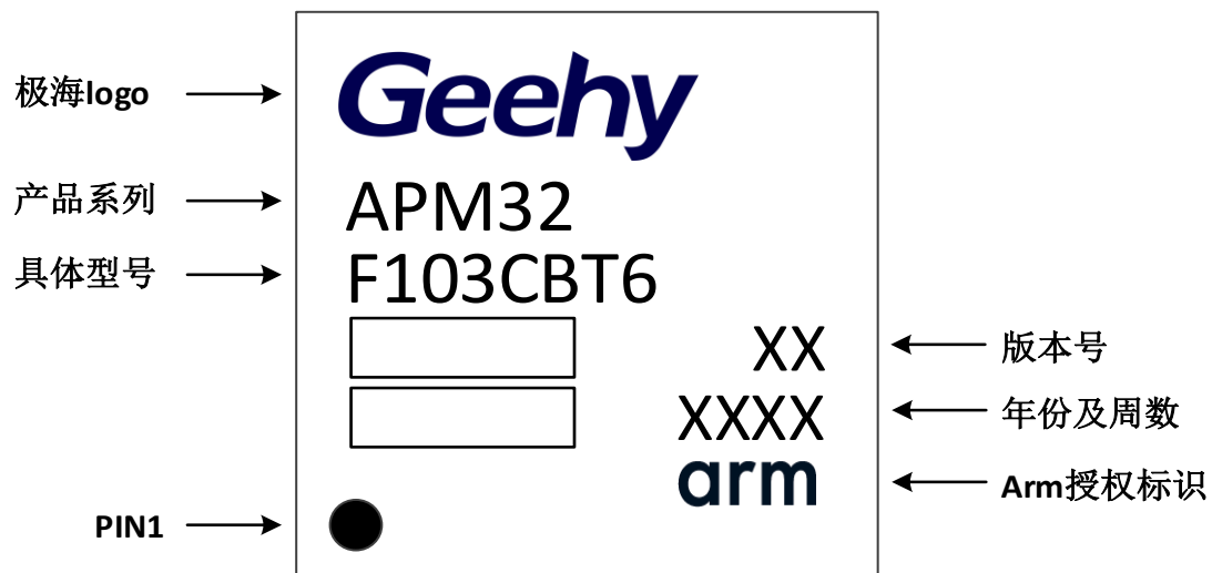
图29 LQFP48 - 48 引脚，7 x 7 mm 标识图
