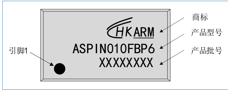
图 7-12 TSSOP20 HK32ASP IN010FBP6 丝印示例
