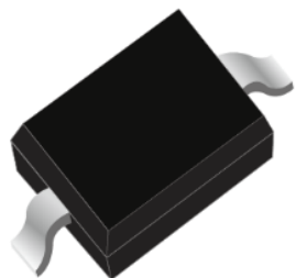
ESD1: UDD32C05L01 SOD-323封装
