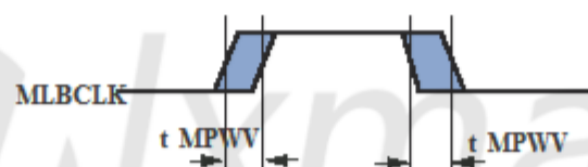
图39. MLB 3引脚和5引脚MLBCLK脉冲宽度变化时序
